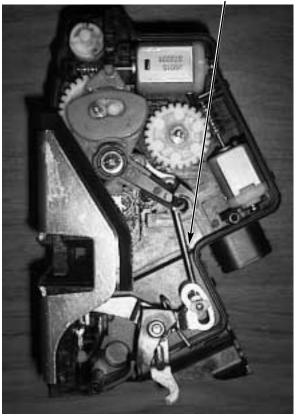
**ACTUATOR IN LOCKED POSITION**
