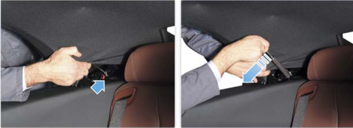
F12 Unlocking the fins
