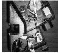
**ACTUATOR IN LOCKED POSITION**
